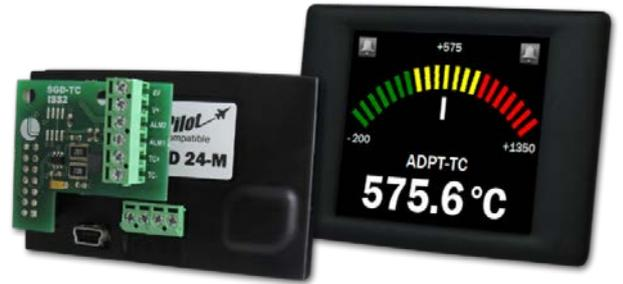
此扩展模块可直接接到PanelPilot兼容显示器上。它含内置冷端补偿 (CJC)，直接由SGD仪表供电。
