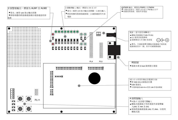
主要的連接就是 SGD 43-A 的連接,作為 SGD 43-A-DK+開發套件所提供的一部份。此模板可以通過 USB 連接綫去連接顯示器後部以直接獲取電源。USB 連接後,可提供電源給顯示器及開發模板。
