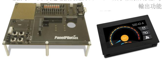
SGD 43-A DK+是一個 PanelPilotACE 系統的開發套件。此套件包含一個 4.3" PanelPilotACE 顯示器、一條 USB 連接綫及一塊開發模板,後者可以連接該顯示器的所有輸入/輸出功能。此模板也包含發光二極管(LEDs)及數碼輸入/輸出開關、四個電位計(用以產生模擬輸入)、可變光度的發光二極管(用以產生 PWM 輸出)以及一個用於測試電路的樣機設計區。此模板也可以連接該顯示器的 RS232、SPI 和 I2C 功能,它們可以用於未來對軟件的更新。
