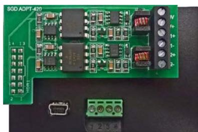
El sistema se puede alimentar a través de un puerto USB conectado al SGD.
