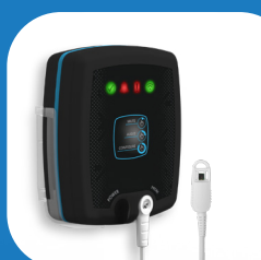
EL-IOT-TH Registrazione dati wireless di temperatura e umidità
